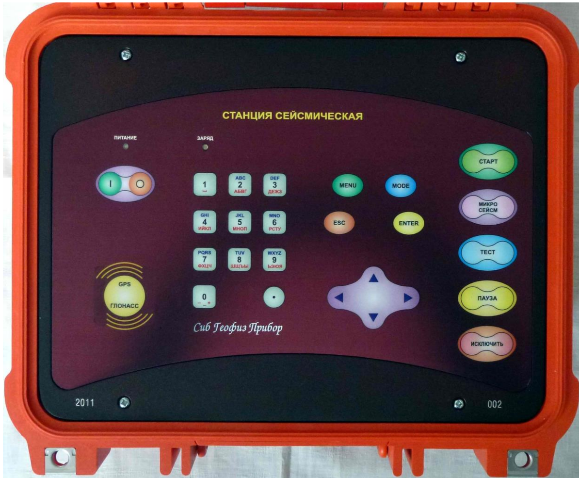
Рис. 3. Лицевая панель (клавиатура) модуля бортового SGD-SMH/СUA.
