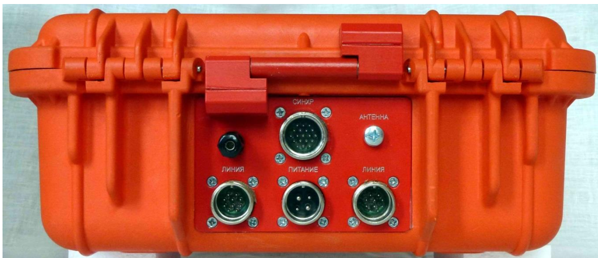
Рис. 4. Задняя панель (разъёмы) модуля бортового SGD-SMH/СUA.
